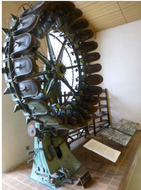
5 Radklebpressmaschine für Schuhsohlen, 1940. Foto © Rose Wagner
